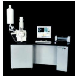
Растворный электронный микроскоп (РЭМ) – прибор, основанный на принципе взаимодействия электронного пучка с веществом, предназначенный для получения изображения поверхности объекта с высоким пространственным разрешением. Современный РЭМ позволяет получить увеличение до 1 000 000 крат, что приблизительно в 500 раз превышает предел увеличения лучших оптических микроскопов.
